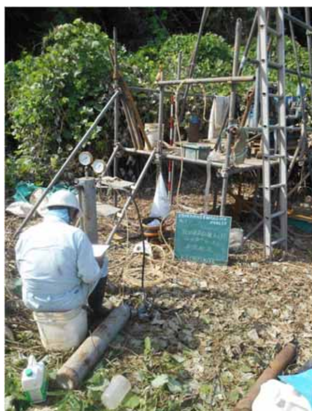
孔内载荷試験(LLT)測定状況 GL- 6.50 m
