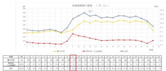
図1 募集要項に関する質問・意見に対する回答書(第2回)別紙5 地域振興電力需要時間値
