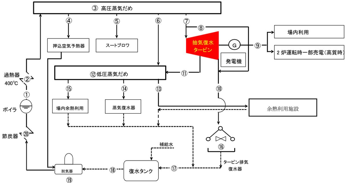
図-1 抽気復水タービンによる熱回収システム
