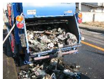
カセット式ガスボンベからの 出火時に損傷した収集車
