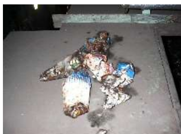
破砕機内で爆発したと思われる カセット式ガスボンベ
