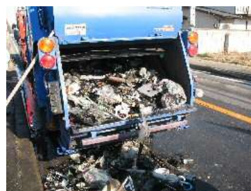
カセット式ガスボンベからの 出火時に損傷した収集車
