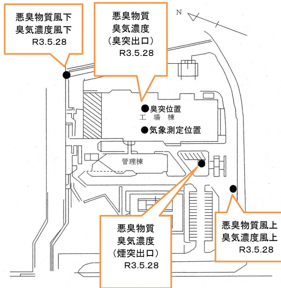
図-2 悪臭物質・臭気濃度測定位置図
